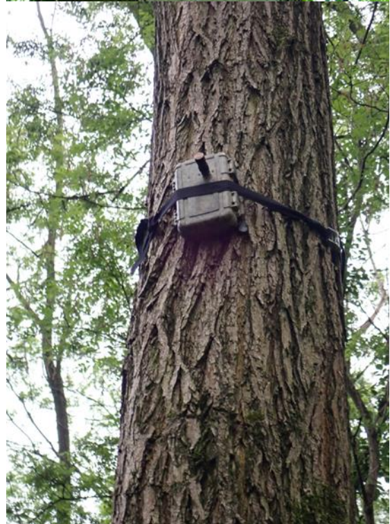
Fot-Terio 1. Pasywne detektory zawieszane na drzewach na badanym terenie: Lunarecorder FR-1 (górne zdjęcia), Anabat Express (dolne zdjęcia) (fot. J. FURMANKIEWICZ).
