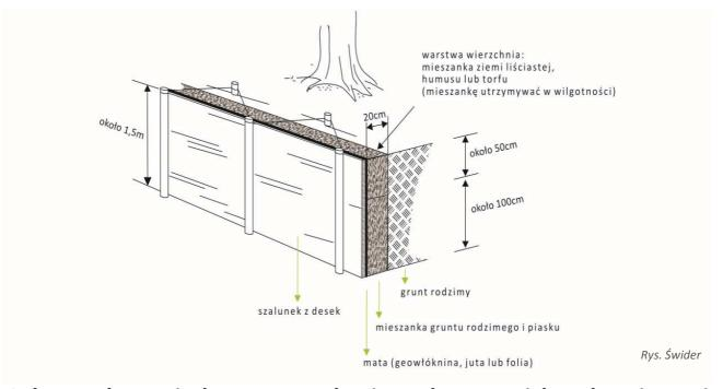
Ochrona korzeni drzew w wykopie polega na ich zabezpieczeniu przed przesychaniem. Ściany wykopu należy zabezpieczyć przed osunięciem ekranem korzeniowym.
